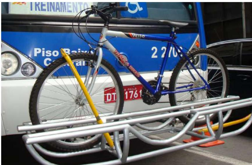
Figura A.32: “Bike Bus” em teste na cidade de São Paulo: ônibus com suporte para transportar bicicleta dos usuários.
