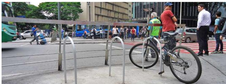
Figura A.39: Exemplo de Paraciclo do tipo “U” invertido em Belo Horizonte (MG).
