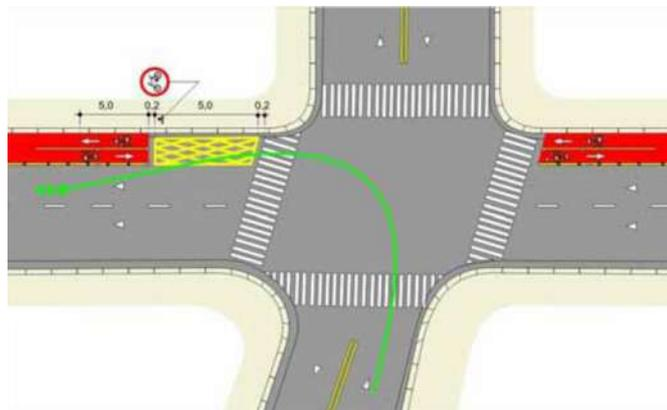
Figura B.34: Situação em que o raio de curvatura dos modos motorizados entra em conflito com a infraestrutura cicloviária, cuja solução proposta é a marcação de uma área de conflito em amarelo.
