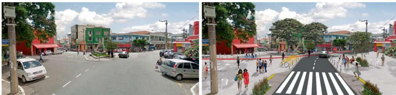
Figura B.8: Redimensionamento de intersecção removendo estacionamentos.
