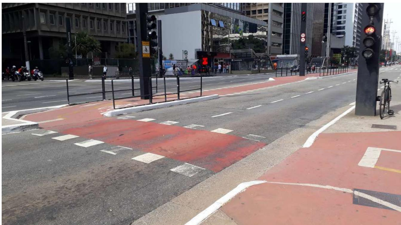
**Figura A.46: Sinalização horizontal com destaque em travessia de cruzamento.**
