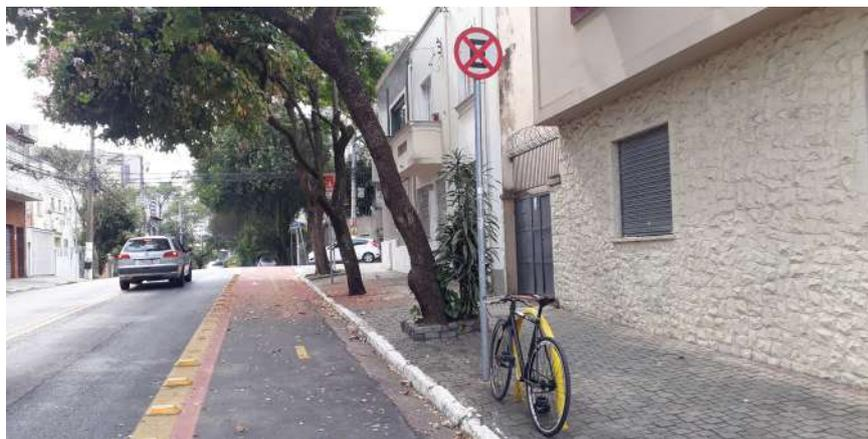
Figura A.40: Exemplo de paraciclo em calçada dentro da faixa de serviços, sem obstruir a passagem de pedestres.
