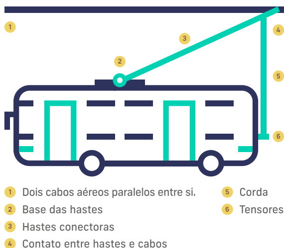
FIGURA 2. Elementos do trólebus
