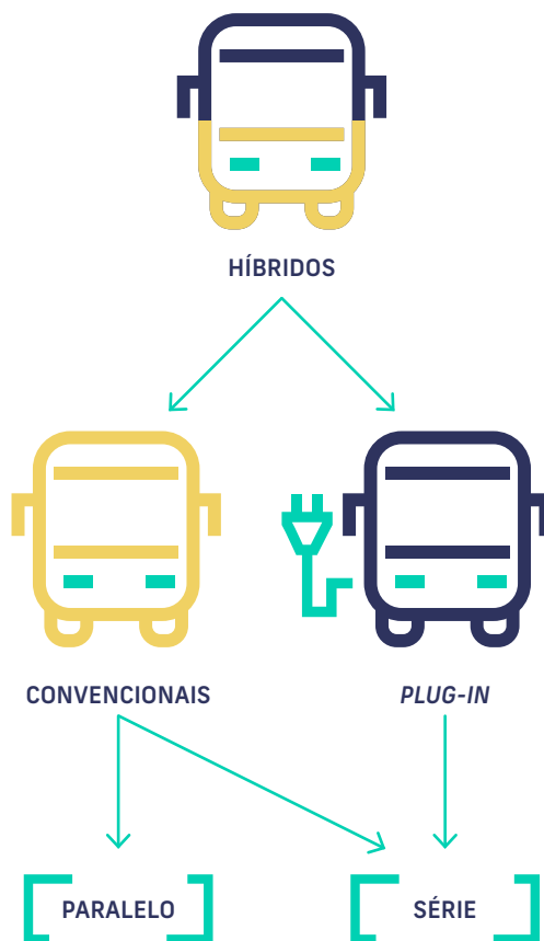
FIGURA 3. Categorias dos ônibus híbridos
